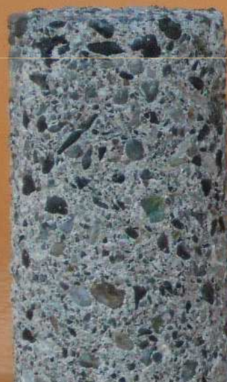
普通 コンクリート
